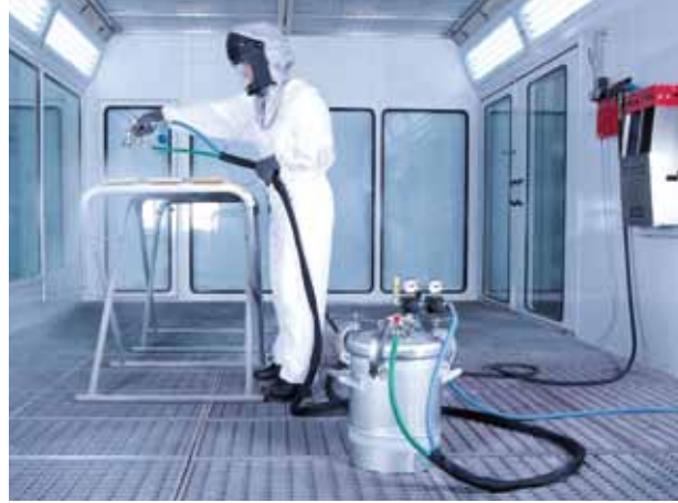
Hohe Flächenleistung und rationelles Arbeiten mit SATA Farbdruckbehältern.
