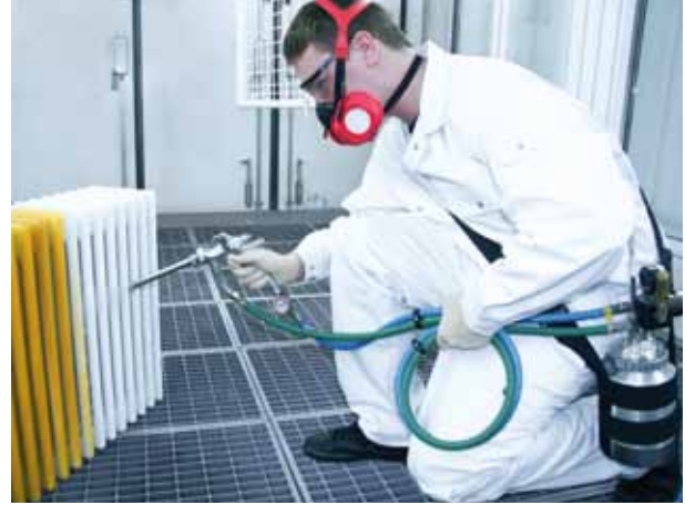
Mobiler Einsatz des SATA mini set 2 mit Schulter-Tragegurt für eine optimale Bewegungsfreiheit des Anwenders.
