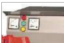
Gehäuse mit Schutzart IP 54
