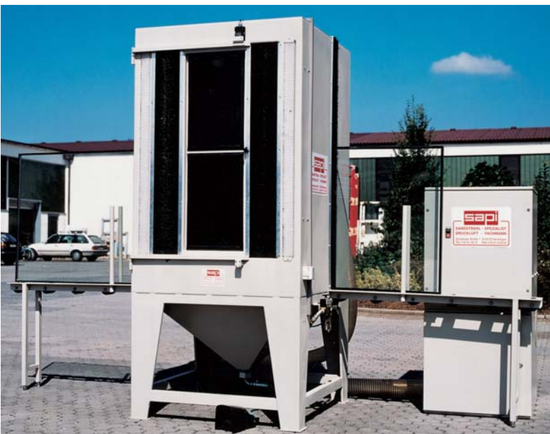
Automatische Drehvorrichtung für Rohre Automatic roller turning device for tube's
