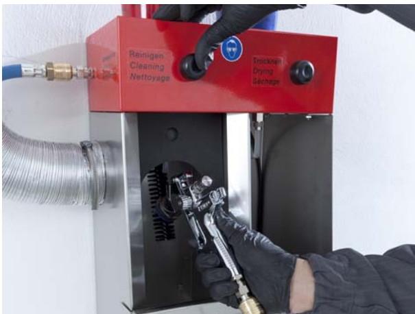
1. Farbkanal und Luftdüse reinigen / spülen (Ø ca. 20 sek.)
